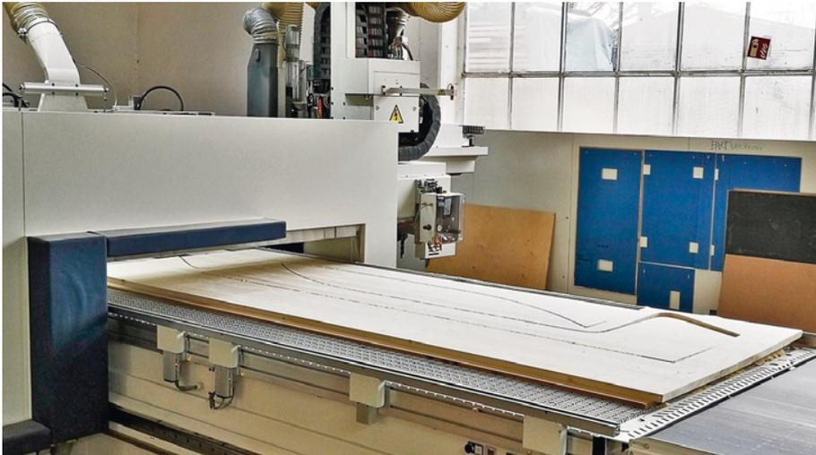
Fertigung der 2400 Elemente aus 27-mm-Leimholz im Nestingverfahren auf einer 5-Achs-CNC beim Nürnberger Verpackungsspezialisten Georg Schrepfer
